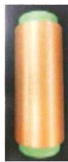
試作糸（ポリプロピレン 190dtex/24f）
